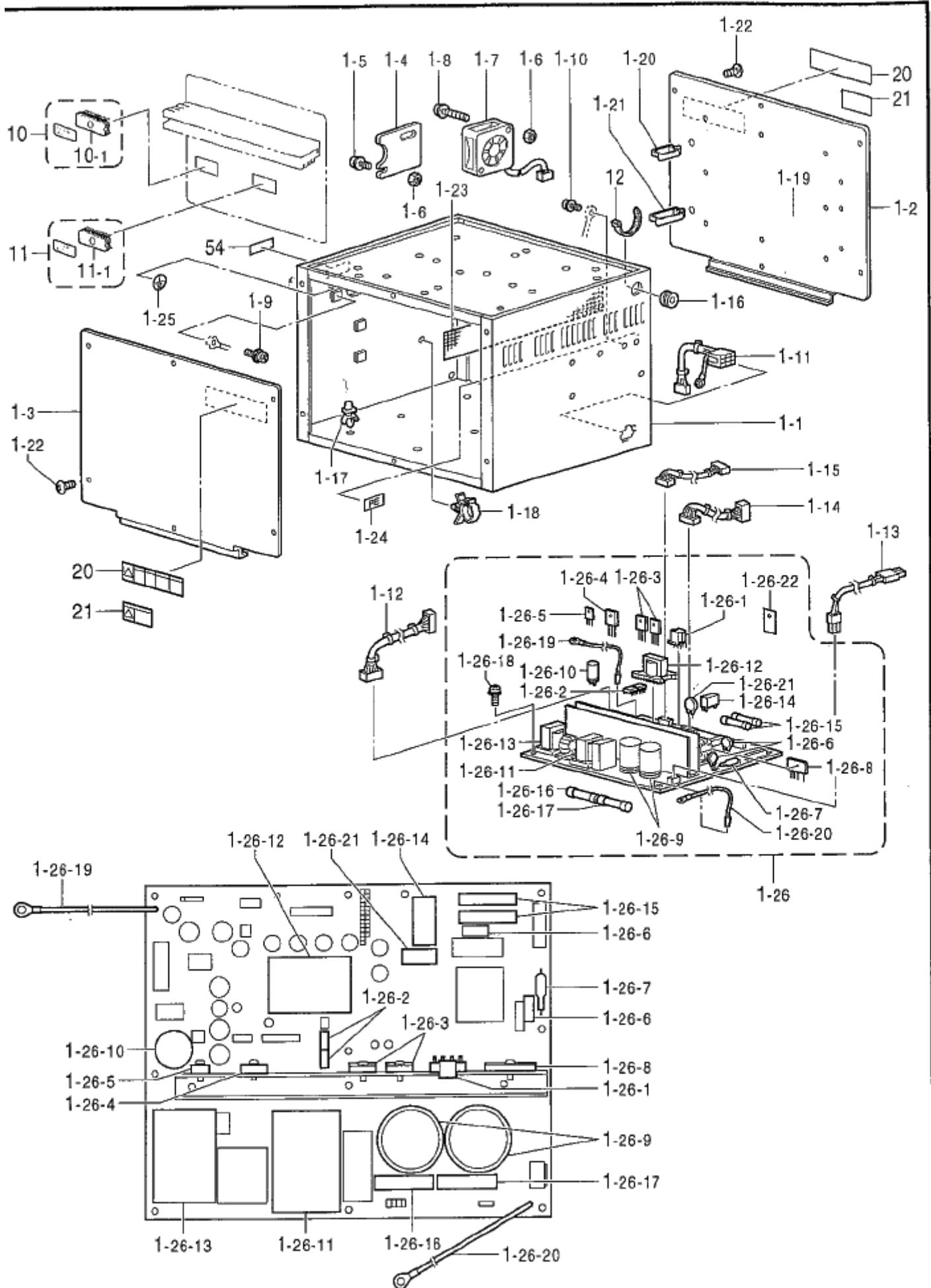
Q1. コントロールボックス関係 / Control box mechanism
